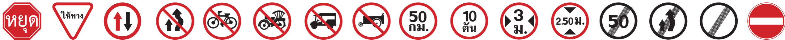
1-1 หยุด 1-2 ให้ทาง 1-3 ให้รถสวนทาง มาก่อน 1-4 ห้ามแซง 1-13 ห้ามรถ จักรยาน 1-14 ห้ามรถสามล้อ ห้ามรถยนต์สามล้อ 1-15 ห้ามล้อ เลื่อนลากเข็น 1-16 จำกัดความเร็ว 50 กม. 1-25 จำกัดน้ำหนัก 10 ตัน 1-26 จำกัดความกว้าง 3 ม. 1-27 จำกัดความสูง 2.50 ม. 1-28 สุดเขตบังคับ ความเร็ว 50 1-37 สุดเขตบังคับ ห้ามแซง 1-38 สุดเขตบังคับ 1-39 สุดเขตบังคับ 1-40 เดินรถ ทางเดียว
